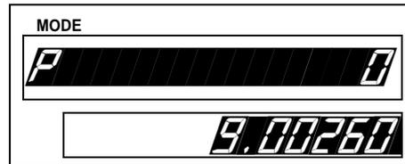
**REMARQUE** La valeur mesurée du segment 2 étant affichée en ordre de marche, le diamètre extérieur à mesurer aura une valeur (incluant une erreur) inférieure au diamètre extérieur réel de l'outil ( $\varnothing 10$  mm dans cet exemple).
