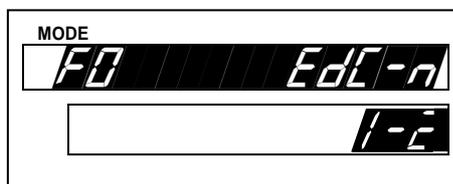
**REMARQUE** Comme le montre la figure ci-dessous, le numéro de la première arête est affiché sur le côté gauche de la ligne inférieure de l'écran, le numéro de la dernière arête sur le côté droit de la ligne inférieure de l'écran.
