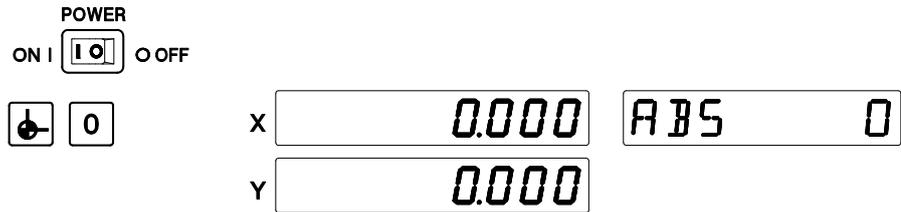
2. Déplacez la table de la machine pour l'aligner sur l'origine mécanique.
