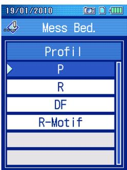
**2** Mit den Tasten [↑][↓] ein für die zu messende Oberfläche passendes Profil auswählen und nochmals [Enter/Menü] drücken.
