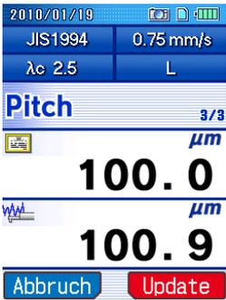
**5** Führen Sie drei Messungen durch, von 0,25mm/s bis 0,75 mm/s (0.010 in/s bis 0.030 in/s).
