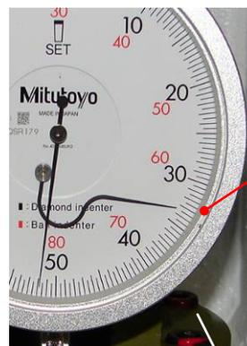
Korrekte Position der Hilfsnadel (ca. 33 bis 34 HR)
