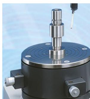
Fonction de centrage et nivellement automatique (A.A.T.)
