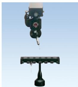
Changeur MCR 20 ; TP20 monté sur tête PH10T
