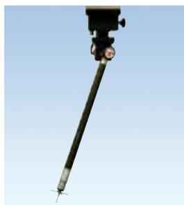
TP20 avec rallonge de capteur de mesure sur tête PH1
