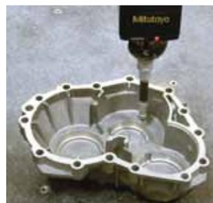
Exemple de mesure : couvercle de transmission
