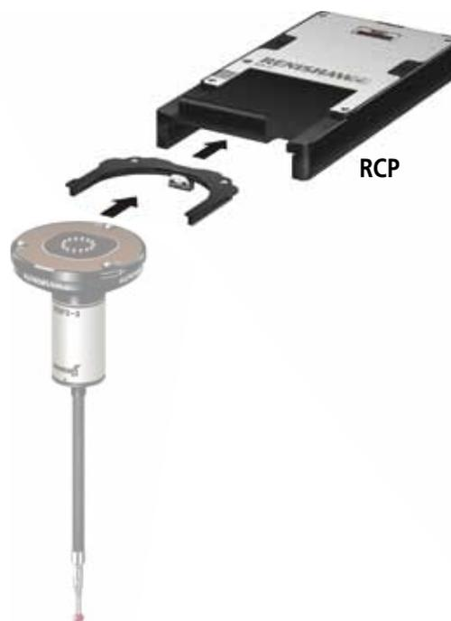
Les modules de stockage REVO RCP TC sont identiques aux modules de stockage REVO RCP mais ils sont dotés d'une alimentation électrique destinée aux systèmes de mesure des modules de palpation REVO RSP 2 et RSP 3. Cette alimentation permet de maintenir les systèmes de mesure à une température constante pour éviter les temps d'arrêt entre chaque changement de module de palpation pendant les processus de mesure.
