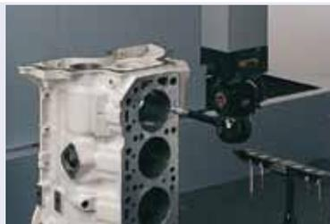
Exemple de mesure : bloc moteur
