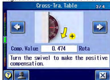
8 Ruotare la manopola della tavola corsa trasversale nella direzione "più" solo dell'entità del valore di correzione e premere
