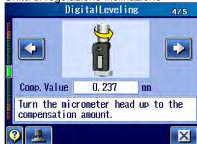
9 Ruotare la testina micrometrica (per regolazione d'inclinazione) fino al valore di correzione e premere
