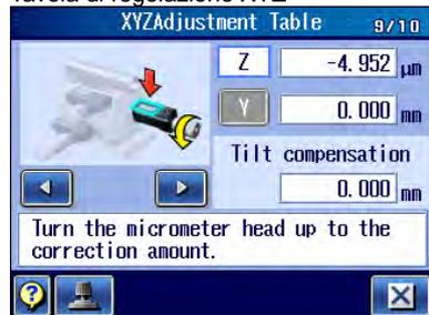
15 Ruotare la testina micrometrica (per regolazione d'inclinazione) fino al valore di correzione e premere
