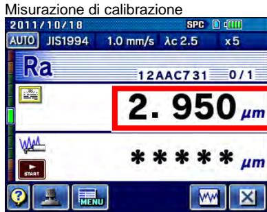
**1** Verificare le condizioni di calibrazione sulla schermata Misurazione di calibrazione.
