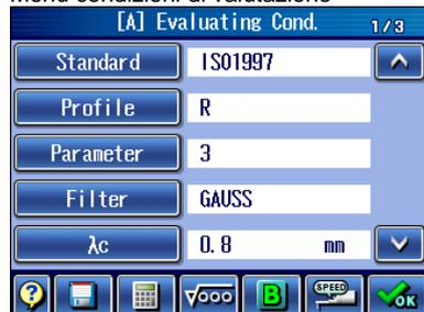
**1** Dopo una misura di rugosità, le condizioni di valutazione possono essere modificate durante la visualizzazione del risultato di calcolo.
