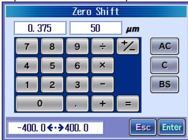
2 Inserire la posizione di sfasamento punto zero e premere
