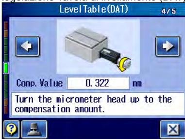
9 Ruotare la testina micrometrica verso l'alto fino al valore di correzione e premere
