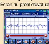
Permet d'effectuer un zoom avant/arrière ou de faire défiler le profil d'évaluation et d'analyser la forme d'onde.
