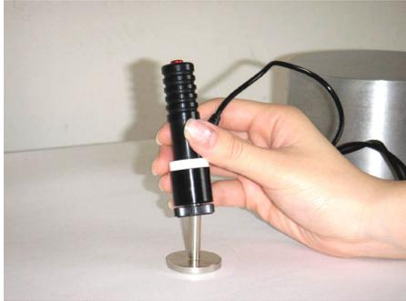
Führen Sie den Schlagkörpereinschub in den Detektor ein, so dass der Schlagkörper erfasst wird.
