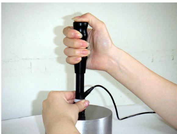
Drücken Sie den Auslöser oben auf dem Griff. Ein Aufprallgeräusch ist zu hören und der Messwert wird angezeigt.
