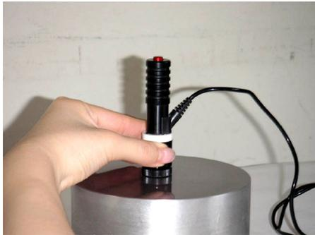
Platzieren Sie den Detektor auf der Messstelle und halten Sie ihn an der Spulenhalterung fest.
